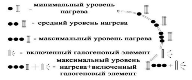
**Внимание!** Если вы установили регулируемый термостат на максимальный уровень нагрева с включенным галогеновым элементом, то после нагрева помещения до заданной температуры, обогреватель автоматически отключится, но галогеновая лампа будет продолжать греть.
